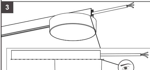
Nach der Installation des Netzteils prüfen, ob das Netzteil fest sitzt und vollständig flach auf der Magnetschiene aufliegt, wobei ein „Klick“-Geräusch als Feedback zu hören sein sollte.
