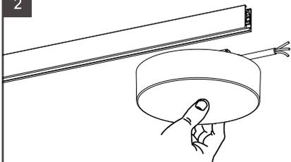
Mit der Schiene ausrichten und vertikal einsetzen.
