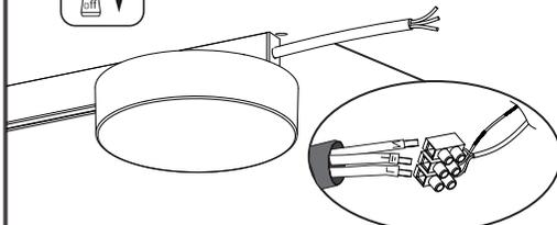
Trennen Sie Neutralleiter, Phase und Schutzleiter vom Netzteil
