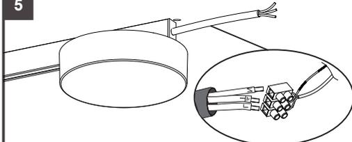
Verbinden Sie den Neutralleiter, die Phase und den Schutzleiter mit den entsprechenden Klemmen.
